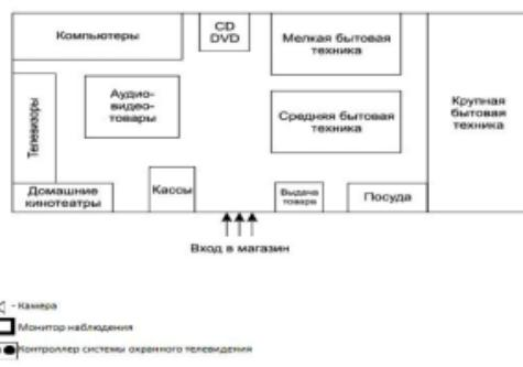
9. Составить схему СОТ (Система контроля и управления доступом) на охраняемом объекте. Разместить на объекте СОТ. Обоснуйте выбор.
